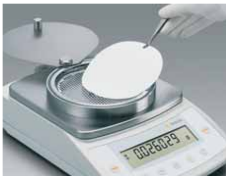
La CPA2P-F: realizzata appositamente per la pesatura di filtri, per es. per la determinazione del particolato generato dalla combustione nei motori diesel.
